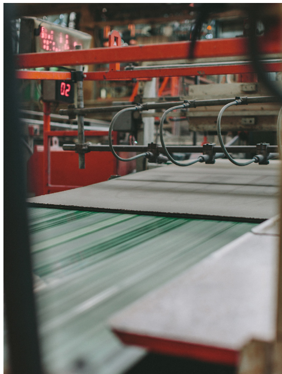
Anschliessend wird der noch feuchte Faserzement zugeschnitten. Fotos: Eternit
